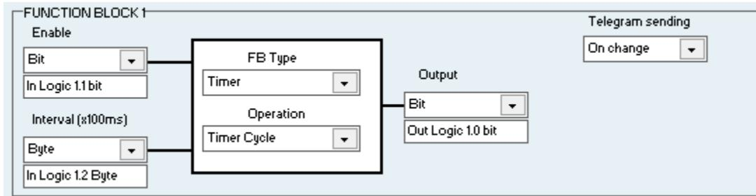
**Enable** - Permite activar o desactivar el temporizador. Esta entrada puede ser asociada a un objeto de comunicación de bus (1 bit, 1 byte o 2 bytes) o una variable intermedia.
