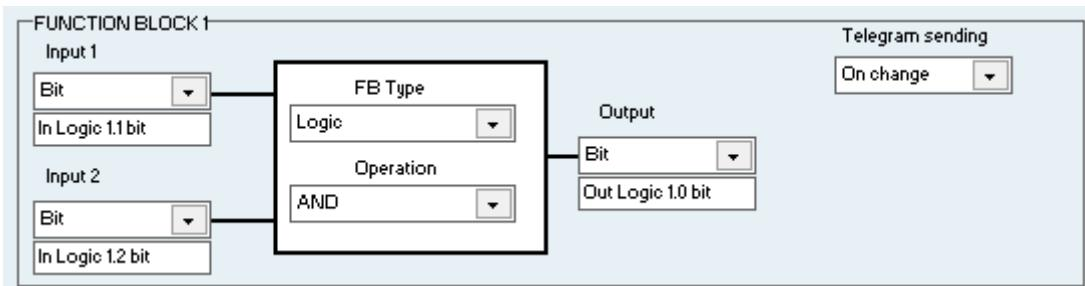
**Input 1 / Input 2** - Seleccione desde dónde se han obtenido los valores de entrada: Pueden ser obtenidos desde el bus seleccionando los objetos de comunicación en los menús desplegables de las entradas (input 1, input 2) de acuerdo al tipo de dato requerido (bit, byte, 2 bytes), o puede tratarse de una constante (CTEX) o de una variable intermedia (VARX).
