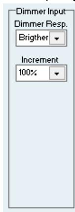
**Dimmer response:** Respuesta del regulador. Define la respuesta de la entrada a la hora de regular. Para pulsación larga el comportamiento puede ser regular siempre hacia arriba (más luminosidad), regular siempre hacia abajo (menos luminosidad) o regular de forma alterna hacia arriba y hacia abajo. El comportamiento para pulsación corta está predefinido y es siempre conmutar encendido/apagado.
