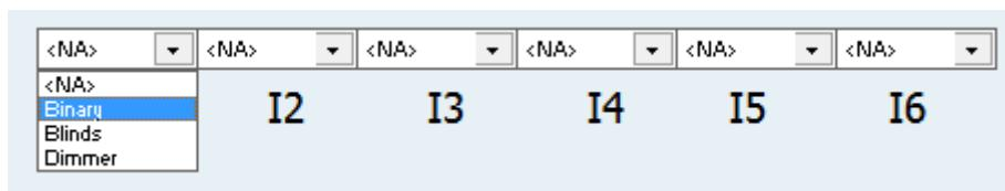
Dependiendo del tipo de salida seleccionado, se puede ocupar más de un slot. Por ejemplo, cuando se selecciona el modo persiana, se reservan dos salidas (salida impar para la fase de subida, y salida par para la fase de bajada).
