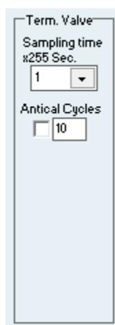
**Sampling time:** Tiempo de muestreo. Factor de tiempo (en base a 255 segundos) para establecer el ciclo de trabajo de la señal PWM generada por la salida.
