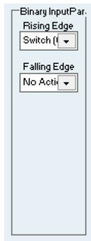
**Rising edge:** Flanco ascendente. Valor enviado cuando tiene lugar un flanco de subida en la entrada (generado cuando la entrada se conecta a referencia). Puede ser configurado para enviar siempre un “1” lógico, un “0” lógico, conmutar entre “0” y “1” o no realizar ninguna acción.
