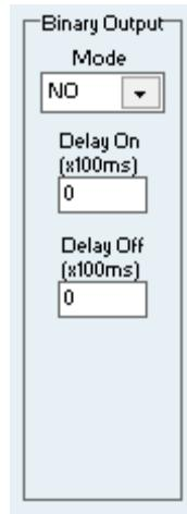
**Mode:** Modo. Puede ser normalmente abierto o normalmente cerrado. En el modo “normalmente abierto” el relé de la salida es controlado siguiendo la lógica estándar: 1 = cerrado, 0 = abierto. En el modo “normalmente cerrado” el relé se controla con la lógica inversa: 1 = abierto, 0 = cerrado.
