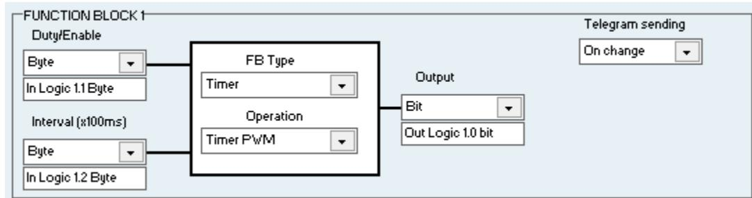
**Duty/Enable** - El ciclo de trabajo admite valores de 1 byte o 2 bytes de 1 a 10. También permite desactivar el temporizador cuando el valor es “0”. Si el valor es 10 significa que la salida estará activada el 100% del tiempo.
