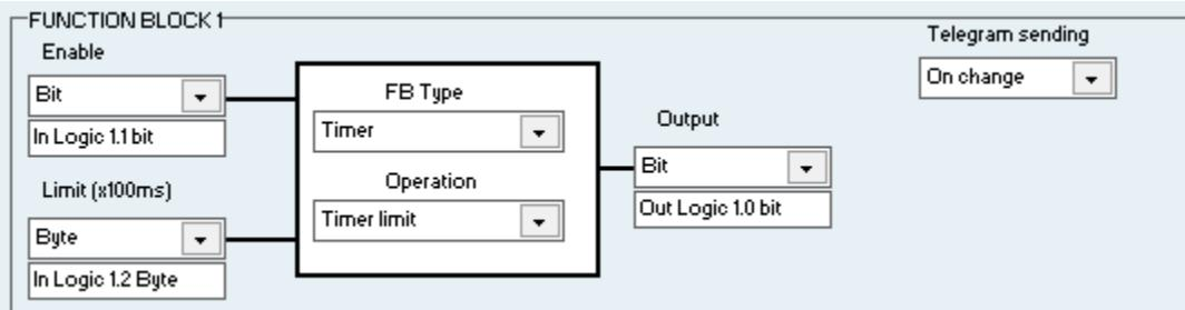
**Enable** - Habilita/deshabilita la función de temporizador con un valor de 0/1. Cuando se envía un “1” a esta entrada el temporizador es activado y la cuenta atrás se inicia con un valor distinto de 0 recibido en la entrada “Limit”. Cuando se envía un “0”, el temporizador es desactivado y la salida envía un 0.
