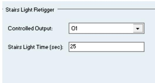
Enviando un “1” al objeto de comunicación asociado a la función se activa la salida. Después, la salida es desactivada automáticamente tras el tiempo configurado. Si se recibe otro “1” antes de que se desactive la cuenta atrás se reinicializa.
