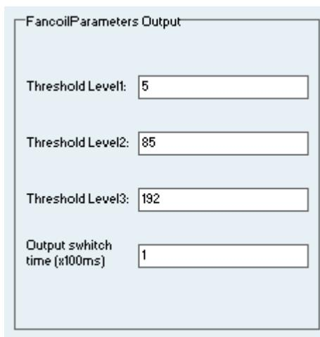
El valor recibido a través del objeto de comunicación de control de fan-coil <<Fan X mode [1 byte]>> es comparado con estos niveles umbral por el actuador (ver la sección 3.4.6 *Descripción de salidas de tipo fan-coil* en la página 13).
