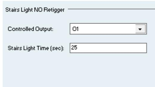
Enviando un “1” al objeto de comunicación asociado a la función se activa la salida. Después, la salida es desactivada automáticamente tras el tiempo configurado. Si se recibe otro “1” antes de que se desactive la cuenta atrás no empieza de nuevo.
