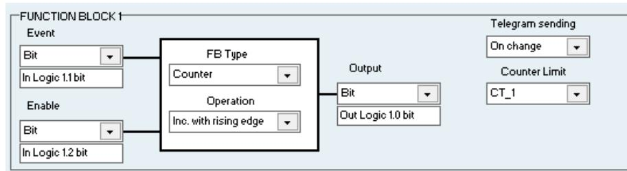
**Counter Limit** – Permite establecer el número de eventos sobre los que el contador envía el telegrama de final. Este valor puede obtenerse de un objeto de comunicación (1 byte o 2 bytes), de un valor constante o de una variable intermedia. Un valor de 10 desactiva el contador.
