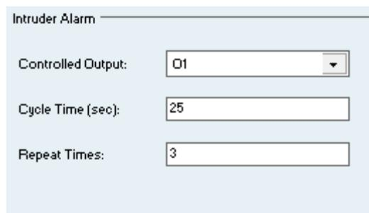
Esta función está pensada para el control de una sirena o cualquier otro dispositivo de alarma. Mediante el envío de un telegrama de valor “1” al objeto de comunicación asociado a la función la salida es activada el tiempo de ciclo definido.
