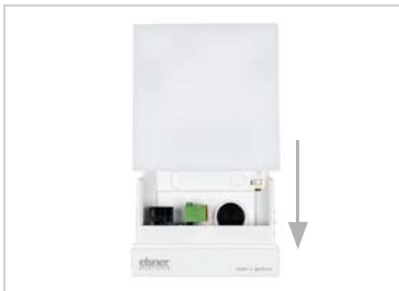
Fig. 13 Introduzca la cubierta sobre la parte inferior. De este modo se crea la unión enchufable entre la placa de circuitos en la cubierta y el zócalo de conexión en la parte inferior.
