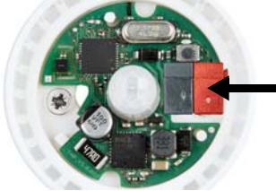
Fig. 8 Introduzca el borne KNX con el cable de bus en la ranura.
