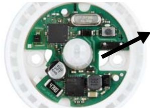
Fig. 6 Extraiga el borne KNX. Pase el cable de bus por la entrada de cable de la base y empálmelo con el borne.
