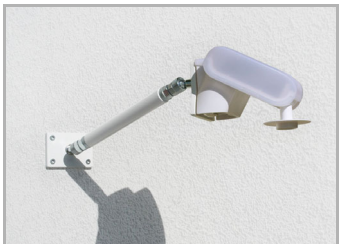
Fig. 7 Como accesorio opcional y complementario, se pueden adquirir en Elsner Elektronik diversos brazos flexibles para el montaje en pared, mástil o viga del sensor. Ejemplo de uso de un brazo: El sensor puede girarse hasta su posición óptima gracias a las articulaciones esféricas
