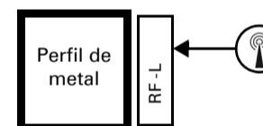
El símbolo de antenas en la carcasa muestra la posición de la antena en el aparato. Este lado no se puede colocar directamente sobre superficies u objetos de metal. De lo contrario, la señal de radio podría sufrir perturbaciones.
