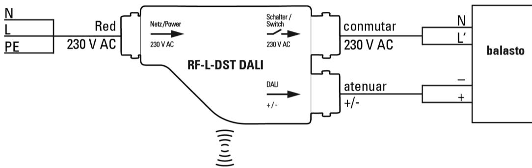
Comunicación por radio con mando a distancia o control para edificios
