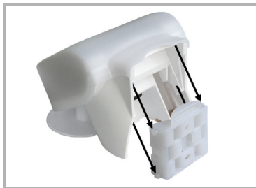
Fig. 17 Deslice el gabinete desde arriba en el soporte montado. Las espigas del soporte deben engatillarse en los rieles del gabinete.
