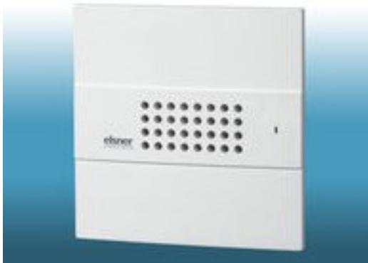
El sensor de calidad del aire KNX AQS mide la concentración de dióxido de carbono en una habitación y entrega una información segura si el aire realmente está "fresco". Ya a partir de 1000 ppm (equivalente a 0,1 %) el aire se percibe como "viciado" – entonces el KNX AQS en el sistema KNX puede transmitir comandos la ventilación a ventanas o aparatos de ventilación automáticamente controlados.
