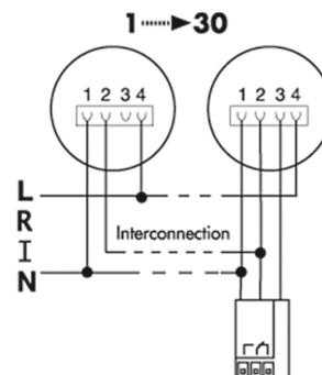
Toma de 230 V CA y conexión en red + relé de conmutación externo (opcional) para conectar equipos externos tales como bocinas, luces intermitentes y dispositivos telefónicos.
