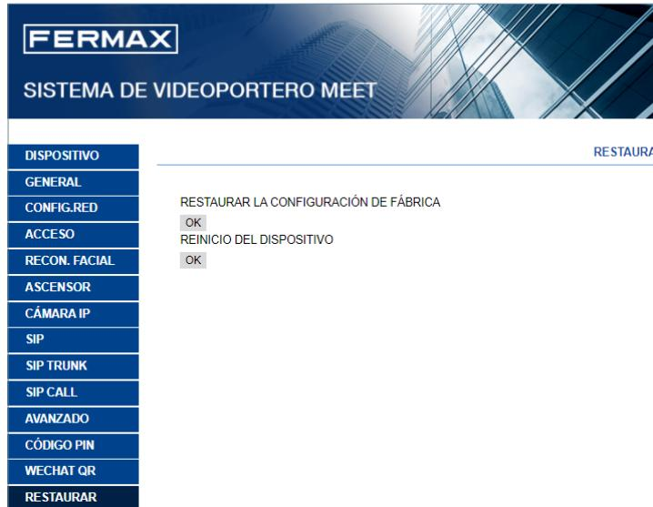
**RESTAURAR LA CONFIGURACIÓN DE FÁBRICA:** La placa se apagará automáticamente, y se encenderá de nuevo con los valores de configuración de fábrica. Se indican abajo los principales valores por defecto, para su referencia.
