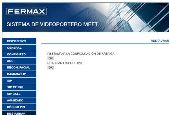
**RESTAURAR LA CONFIGURACIÓN DE FÁBRICA:** La placa se apagará automáticamente, y se encenderá de nuevo con los valores de configuración de fábrica. Se indican abajo los principales valores por defecto, para su referencia.
