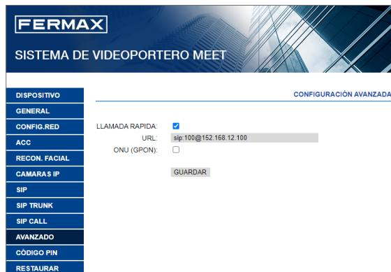
**LLAMADA RÁPIDA:** Estando la placa trabajando en modo PLACA INDIVIDUAL, es posible asociar el botón de llamada a vivienda a una llamada directa a un determinado dispositivo (monitor, teléfono SIP, smartphone Con FERMAX MEET ME APP, etc.).
