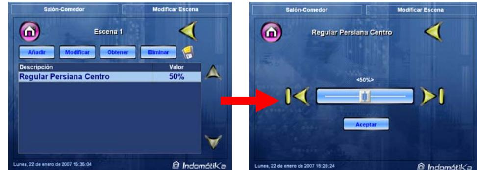
Gradúe el valor del elemento mediante la barra de regulación presionando el cursor y desplazándolo a la derecha (por ejemplo, aumento de la luminosidad) o a la izquierda (disminución de la luminosidad). Por último pulse el botón **Aceptar**.
