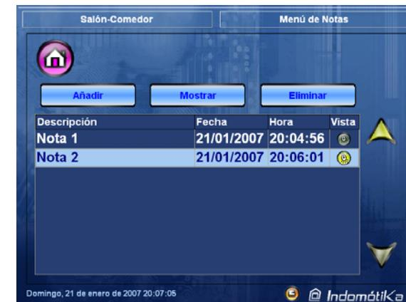
Los tres botones de la parte superior permiten añadir, mostrar y eliminar notas. En la parte central se encuentra una lista con las notas almacenadas en el sistema junto con la fecha y hora de su creación, así como un indicador que informa a los usuarios si la nota ha sido o no leída. Cuando existan notas pendientes de ser leídas, parpadeará en la parte inferior de la pantalla (barra de estado) un indicador advirtiendo de ello.
