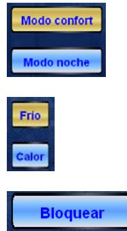
**Modo Confort/Noche.** Este control indica si el termostato de zona trabaja en modo confort o en modo noche (o stand-by) y le permite cambiar dicho modo de trabajo.
