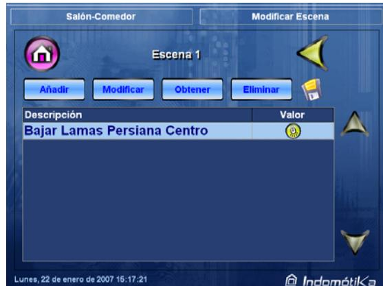
Para cambiar el valor de dicho elemento localícelo en la lista, pulse encima de él y seguidamente pulse el botón **Modificar**.
