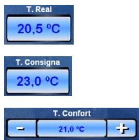
**Temperatura Real.** Es un indicador que informa de la temperatura real de la zona o localización a la que pertenece el termostato.
