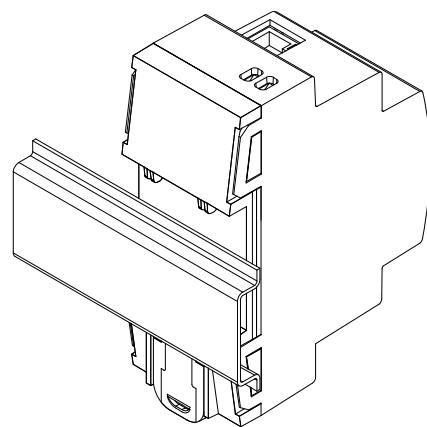
Figure 2: Montaje de RemoteBOX en carril DIN
