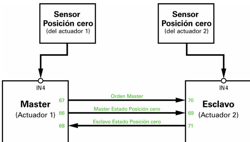
**Sensor de Posición cero Master en la entrada 4 (IN4) del actuador,**
