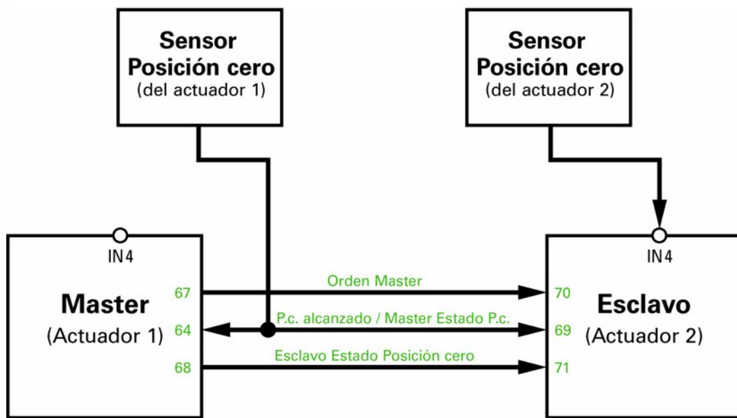
**Sensor de Posición cero Master mediante Bus, Sensor de Posición cero Esclavo mediante Bus:**
