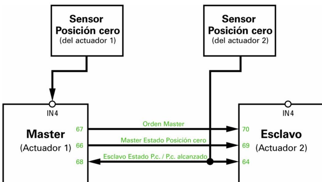
**Sensor de Posición cero Master mediante Bus:**
