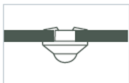
Montaje en falso techo
