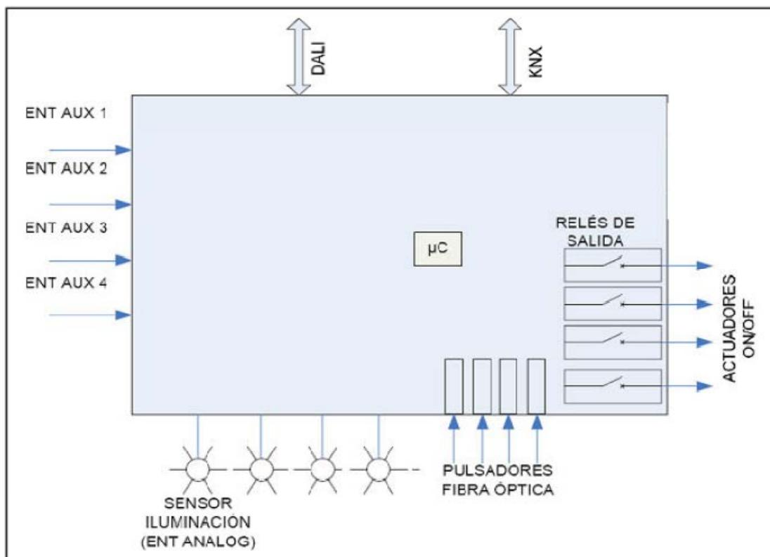
Nuestro nodo registra los cambios de estado en las entradas (Auxiliares, analógicas y de fibra óptica), estos cambios se adaptan al protocolo de comunicaciones KNX y se envían al PC.
