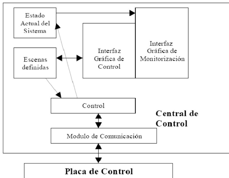
La figura de arriba muestra los componentes software de la central de control:
