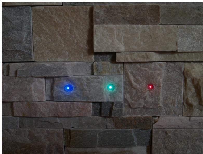
Este sistema permite introducir un interruptor en volúmenes prohibidos por el Reglamento de Baja Tensión y en zonas con ambientes explosivos ya que el usuario solo entra en contacto con fibra óptica de plástico la cual no lleva tensión ni genera arco eléctrico. Funciona incluso con la terminación de fibra óptica sumergida bajo el agua.
