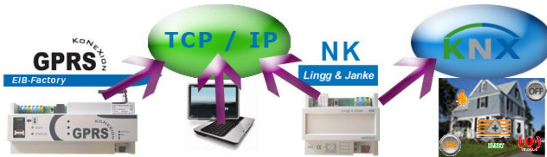
Además, es capaz de crear una conexión a Internet vía GPRS, permitiendo la monitorización del bus de forma remota, accediendo de esta forma a la 'visu' del NK o a la monitorización del bus mediante el ETS., aunque la instalación no esté dotada de conexión a Internet.
