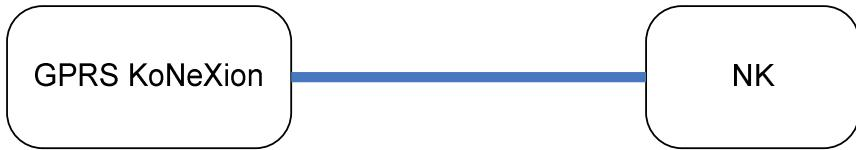
En este caso la comunicación entre el GPRS KoNeXion y el NK es directa, utilizando un **cable de red cruzado**.
